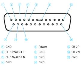
Unbelegte Pins dürfen nicht mit einem Signal belegt werden. Unassinged pins must not be wired.
