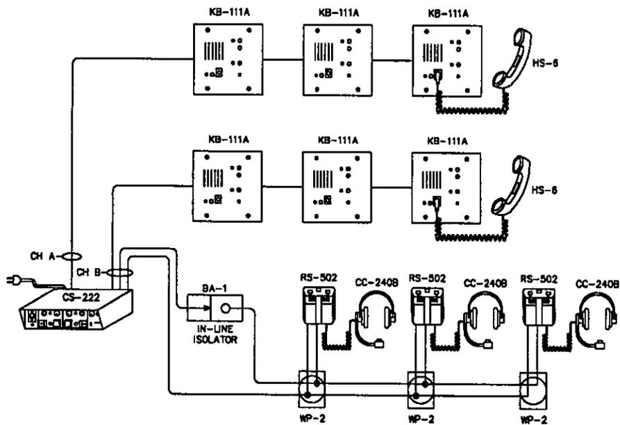
SECTION 3 / OPERATION OF THE CS-222 2-CHANNEL INTERCOM STATION
