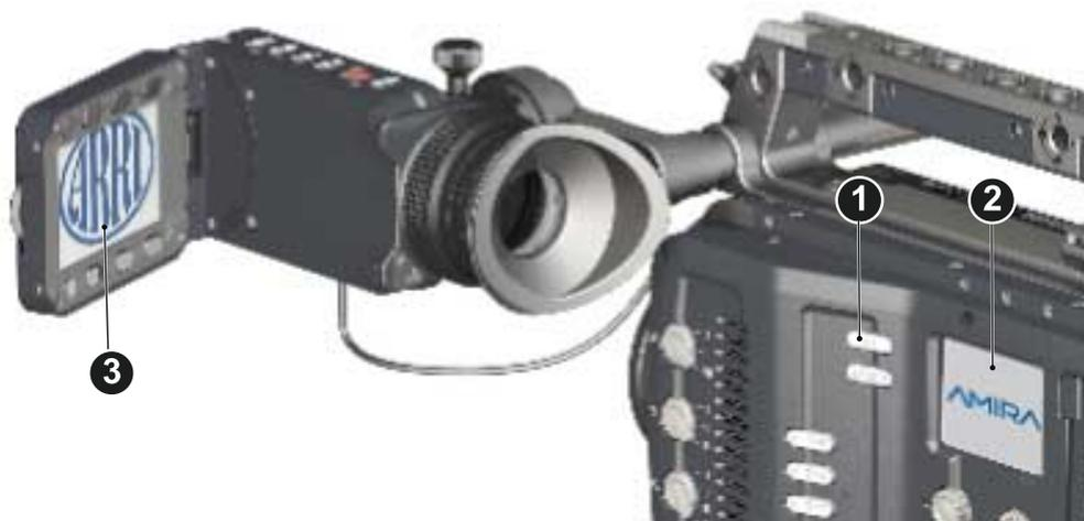
1. **To switch on:** Press the power button (1).
